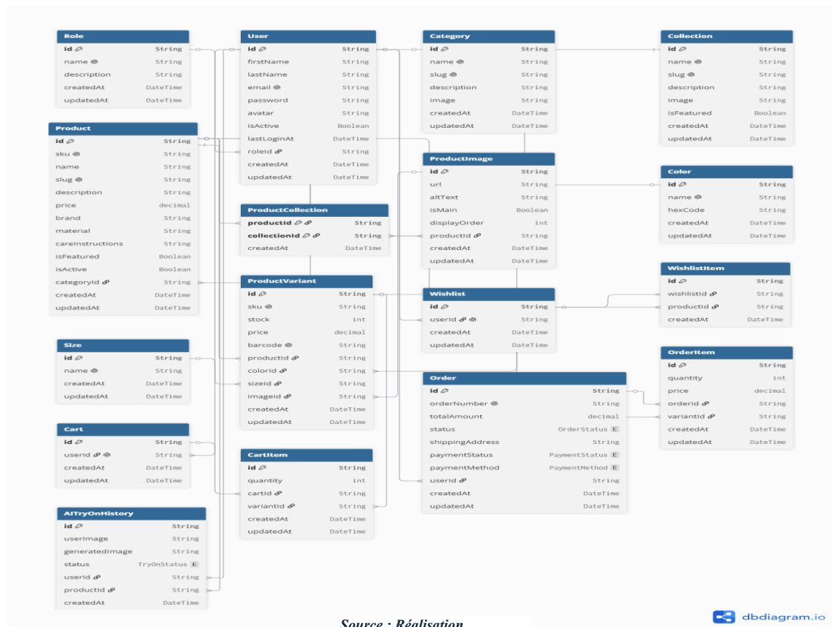
Figure 2.3 : Schéma relationnel de la base de données (ERD Prisma)
